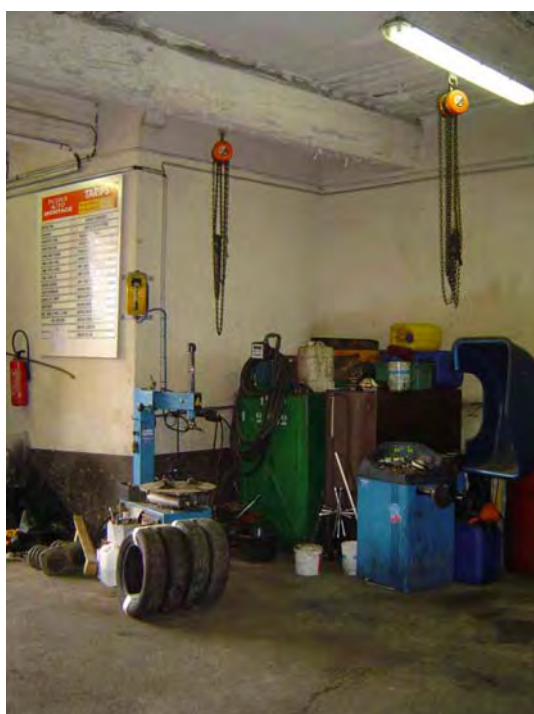
Palans fixés au plafond permettant de surélever le matériel le plus sensible et le plus coûteux en cas de crue
